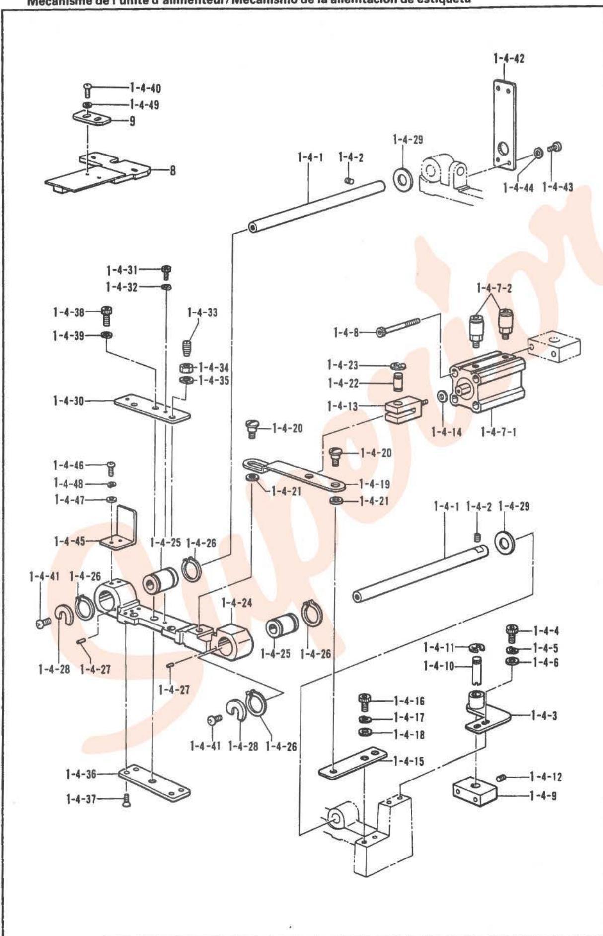
R4. フィーダー単位関係 / Feeder unite mechanism / Transport-Kupplung /
